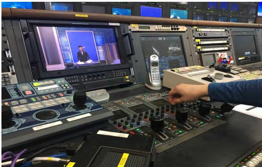
그림 1.2 방송 송출 직전 송출 화면과 F/M 상의 화질 신호 수치 확인하는 모습, KBS 대전방송총국 제공
